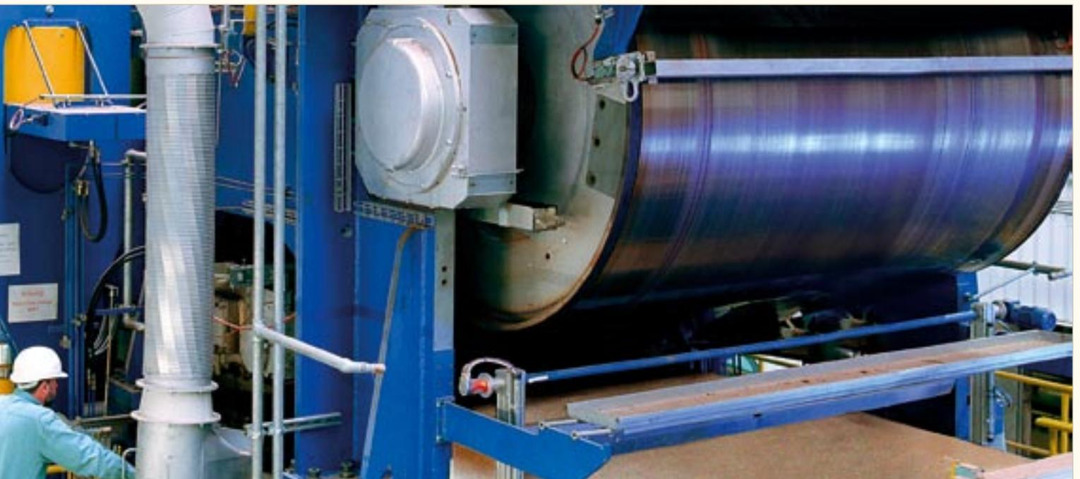
Der DIEFFENSOR arbeitet berührungslos. Für die Messwertaufnahme befinden sich unterhalb des Materials die Röntgenquellen, oberhalb die hochgenauen Sensoren. Je nach spezifischer Dichte und Menge des Messgutes wird mehr oder weniger Röntgenstrahlung von den Sensoren erfasst. Daraus werden die Messdaten abgeleitet.
